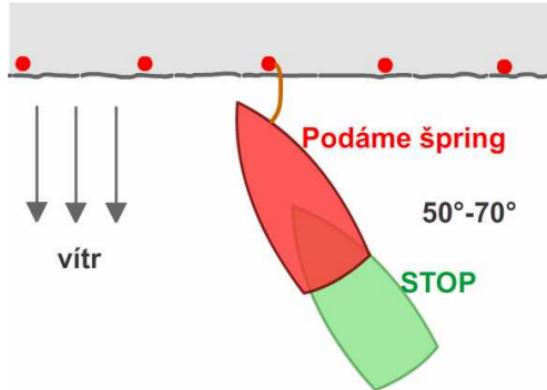
V momentě kdy máme na břehu uvázaný špring vychýlíme kormidlo na opačnou stranu než se chceme vázat a nastavíme telegrafem lehce vpřed – chod vpřed můžeme začít silným manévrem (2-3 sekundy). Tímto manévrem se nám začne zád přibližovat k nábřeží – loď se zavěsí do špringu. Následně opět přivážeme zád, příd, vypneme motor a vyrovnáme kormidlo.
