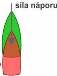
**Boční síla šroubu** – síla reakce  $R$  působí proti otáčení lodního šroubu. List šroubu, který je v horním položení (list 1) překonává odpor, který vytváří sílu reakce  $R_1$ . List 2 šroubu vytváří také sílu reakce  $R_2$ , ale díky zvětšení hydrostatického tlaku je tato síla
