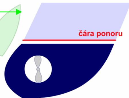
Při vychýlení kormidla maximálně vlevo, nastavení telegrafo na pohyb velmi pomalu vpřed a BT na pohyb přídě vpravo lod' pluje prakticky do boku (směrem vpravo) s minimálním pohybem směrem vpřed. Je to díky kombinaci boční síly šroubu (tlačí záď vpravo), síly náporu od kormidla (tlačí záď vpravo a brzdí rozjezd lodi) a díky síle od BT (proud vody), která tlačí příd' vpravo. Na obrázku níže je vidět složení sil a pohyb lodi do boku.
