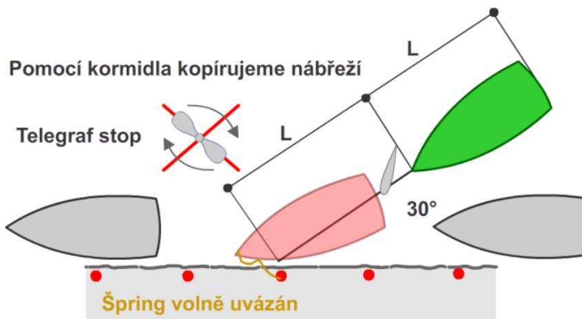
V momentě kdy je špring zavěšen a na volno uvázán k lodi a nebo těsně předtím než je špring zavěšen a uvázán k lodi vyrovnáme kormidlo a začneme pracovat motorem vzad (vždy je nutné první vyrovnat kormidlo a teprve potom začít pracovat motorem vzad). Telegraf nastaven na pohyb vzad, tak abychom zastavili pohyb lodi dopředu. Loď se nám díky **boční síle šroubu**, který pracuje vzad, „položí“ rovnoběžně s nábřežím.
