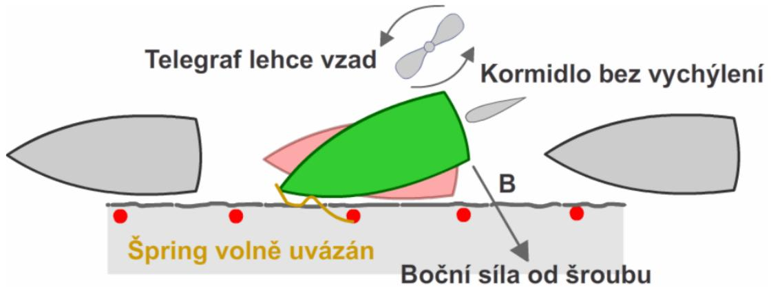
V momentě kdy se již loď nepohybuje a je rovnoběžně s nábřežím - dopneme ručně špring. Po dopnutí špringu vychýlíme kormidlo maximálně vpravo a nastavíme telegraf do pozice lehce vpřed. Loď se tzv. **zavěsí do špringu**. Potom uvážeme silně zád' a nakonec podáme přídové lano. Vypneme motor a vyrovnáme kormidlo. (pozn. nikdy nedotahujeme přídové lano dřív než máme uvázanou zád' lodi)
