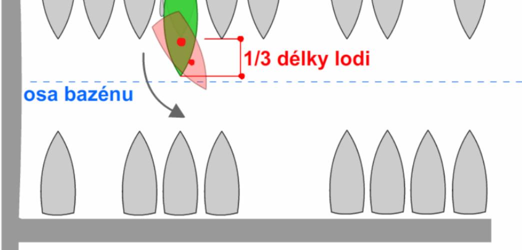
V případě vyplutí na obrázku výše kontrolujeme (vyplutí vlevo) kontrolujeme vzdálenost naší zádě od levého boku přídové části lodi vpravo. Pokud máme pocit, že lod nestočíme jelikož jsou lodě naproti již velmi blízko můžeme použít silný manévr na stranu na kterou měníme kurz. To ovšem v případě, že naše rychlosť není nijak velká. Čím je větší rychlosť lodi, tím je menší účinnost silného manévru.
