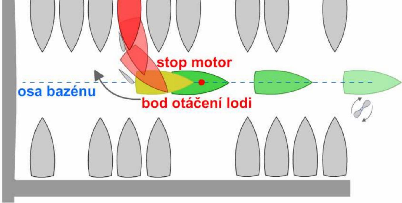
Při vplutí do pozice jako je na obrázku je nezbytné, aby jeden člen posádky kontroloval levobok a jeden pravobok. Dva členové posádky by se měli plně věnovat vytažení mooringu z vody a jeho uvázání na přídi. Záďová lana, která jsou již připravena (tak jako fendry) na přivázání před vplutím do maríny si většinou pohlídá kormidelník či skipper sám.
